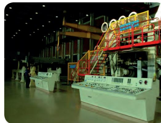
В 1994 году была пущена в работу высокоскоростная бумагоделательная машина №8 фирмы Voith (Германия), сконструированная на самом современном техническом уровне. Скорость ее работы составляет 1300 метров в минуту, производительность – 250 000 тонн продукции в год.
