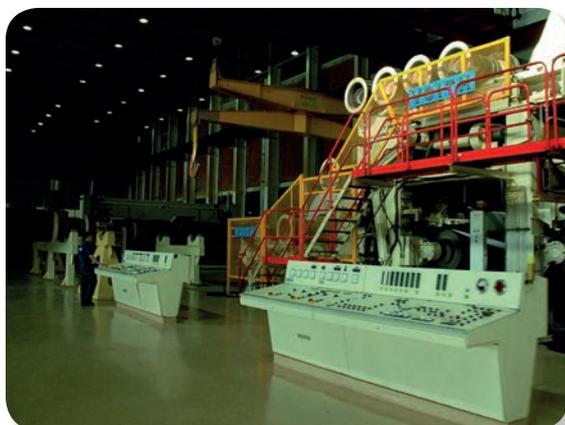
В 1994 году была запущена в работу высокоскоростная бумагоделательная машина №8 фирмы Voith (Германия), сконструированная на самом современном техническом уровне. Скорость ее работы составляет 1300 метров в минуту, производительность – 250 000 тонн продукции в год.
