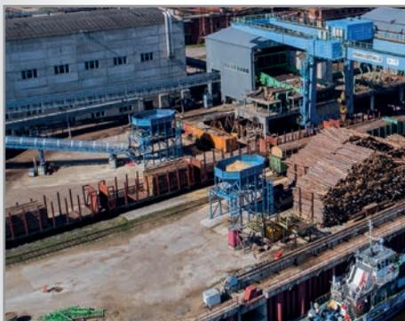
в 2016 году компания запустила новую автоматизированную линию по выгрузке и транспортировке древесного сырья, представляющую собой приемный бункер-накопитель и ленточные транспортёры, подающие на кучевое хранение товарную щепу, обеспечивая ее смешивание с технологической щепой, вырабатываемой в компании. Это позволило улучшить качество сырья, поступающего в цех термомеханической массы.
